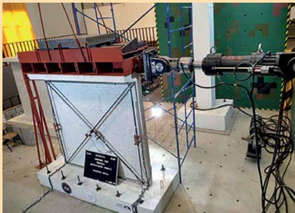
Ensayo cíclico de muro de mampostería confinada en el Muro de Reacción de la EMI (Sedena)
