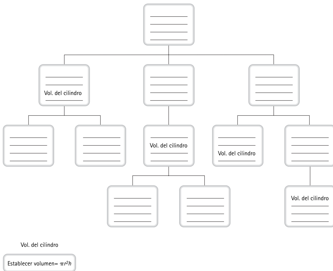
Figura 4-6 Gráfica de estructura de módulo semijerárquica con un módulo compartido
